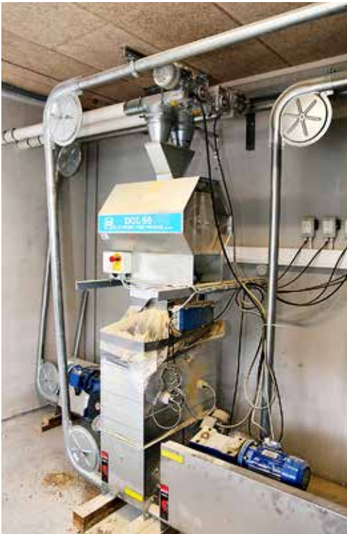
VEIER: I øverste del av fôringsanlegget sitter fôrvekta, som veier inn 20 kilo fôr om gangen. Fôringsanlegget fyller tørrfôringsautomatene helt fulle to ganger daglig.
